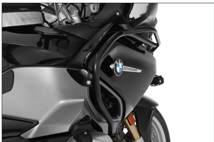
Rohrverbund, gefertigt aus 25- und 18- Millimeter Präzisions-Stahl (Art.-Nr.: 44140-102)
