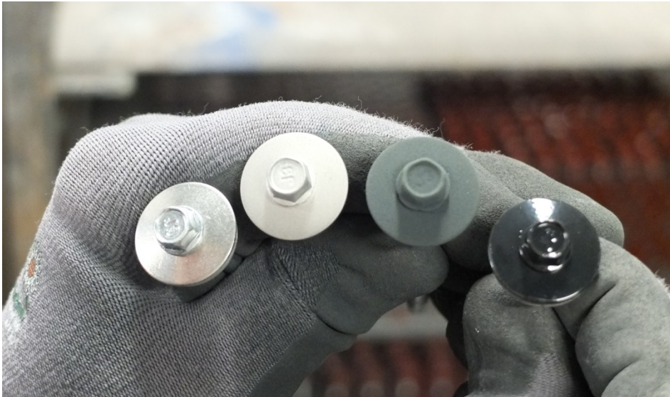
Bildunterschrift: Die Arbeitsschritte von links nach rechts: Unbearbeitete Serienschraube, Sandstrahlen, Pulverlackierung, fertige Schraube mit eingebranntem Lacküberzug.
