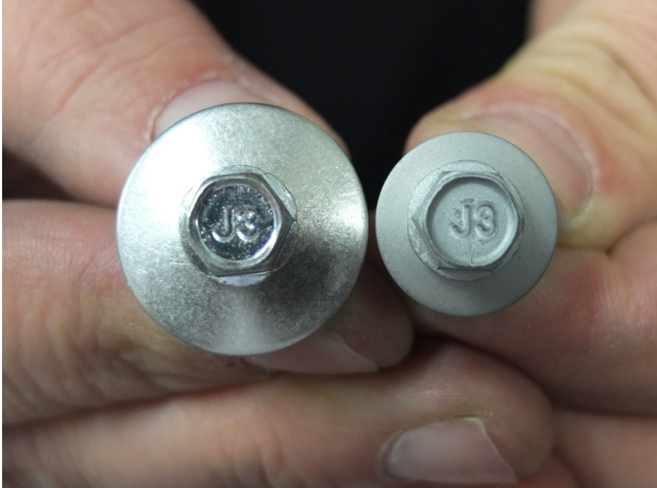
Bildunterschrift: Zum Vergleich: Links die unbearbeitete Schraube, rechts die raue Oberfläche nach dem Sandstrahlvorgang.
