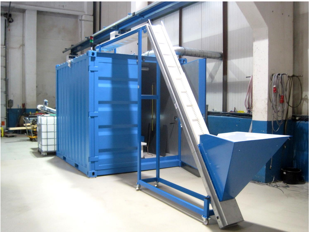
Kontinuierlich arbeitende Schockwellenanlage für den industriellen Einsatz.
