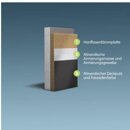
Natürlich von Vorteil: Das neue Fassadendämmsystem von Caparol basiert auf einer Dämmplatte aus natürlichen Hanffasern, die ausgewogenen Schutz vor Kälte, Hitze, Schall und Feuchtigkeit bietet.
