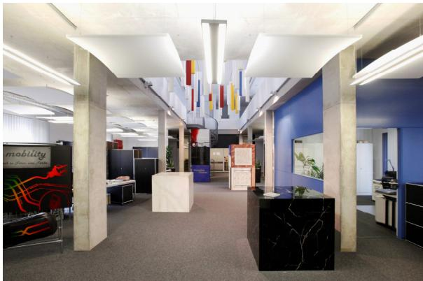
Exponate des Malerhandwerks schmücken den Hauptraum der neuen Büroräume des Bundesverbandes für Farbe-Gestaltung-Bautenschutz. Als Akustikmaßnahme sind im Erdgeschoss konkave CapaCoustic Melapor-Deckensegel unter die Betondecke gehängt worden, die durch entsprechende Beleuchtung sehr atmosphärisch wirken.
