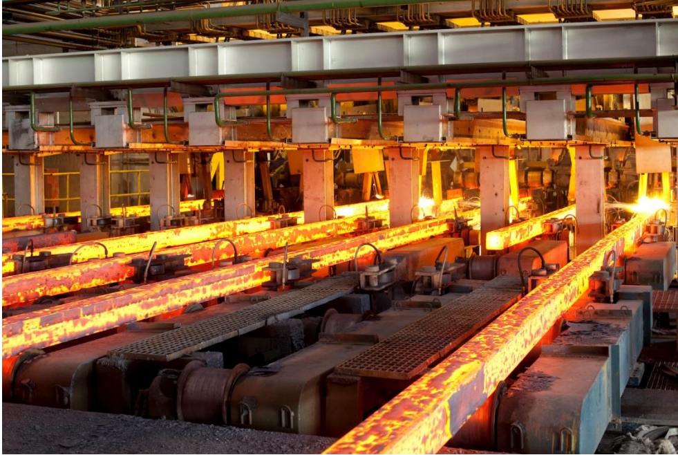
Strangguss auf acht Strängen mit Hochgeschwindigkeitstechnologie von SMS Concast.
