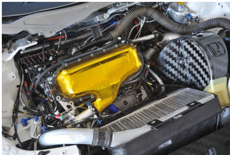
Das Herzstück des neuen Honda Civic WTCC: der Rennmotor HR412E.
