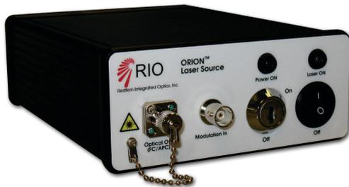
Aufgrund ihrer Ausstattung und Leistungsmerkmale ist die ORION Laserquelle besonders für den anspruchsvollen Laborbetrieb geeignet. Sie findet ihren Einsatz bei Applikationen die absolute Genauigkeit, Stabilität und Zuverlässigkeit benötigen, wie zum Beispiel die Messung von Temperatur bzw. Druck und Zug über größere Entfernungen und andere metrologische Messmethoden.
