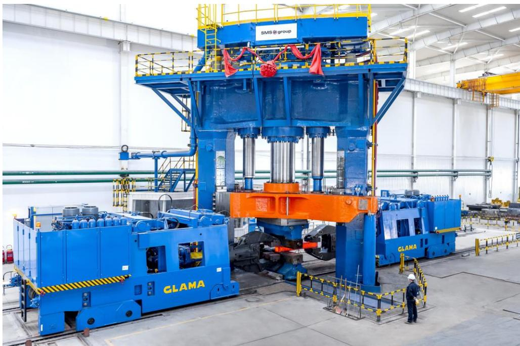
Die neue von der SMS group gelieferte 63/80-MN-Hochgeschwindigkeits-Freifformschmiedepresse im Betrieb bei WST.
