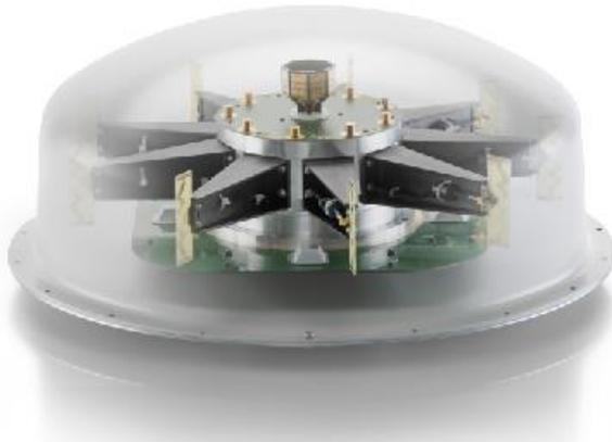
**Photo 2 : Le cœur de l'ADFA 2 se compose d'une série de neuf éléments d'antennes (dipôles) rayonnant autour d'une antenne de référence omnidirectionnelle centrale. Désormais, l'antenne est dotée d'un nouveau plan inférieur pour la gamme de fréquence de 10 à 200 MHz et un supérieur pour la gamme de 2,7 à 8 GHz en raison de l'élargissement de la gamme de fréquence aux deux bouts de l'échelle.**
