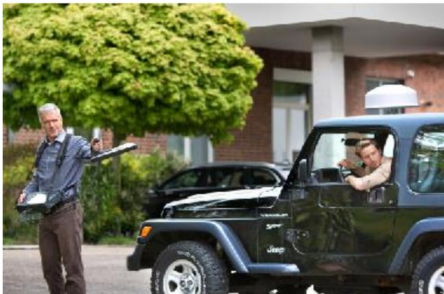
**Photo 1 : Pour l'intervention mobile, l'ADFA 2 est simplement fixée au toit du véhicule à l'aide d'un pied magnétique et reliée au SignalShark installé dans l'habitacle. Si le technicien de mesure doit entrer dans un immeuble pour suivre les derniers mètres jusqu'à la source, il utilise l'antenne portable pour localiser la source.**
