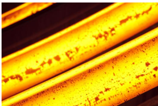
Gießen von rechteckigen Vorblöcken auf einer Stranggießanlage der SMS Concast.
