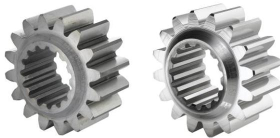
Ingranaggi di un cambio da corsa prima e dopo la lavorazione
