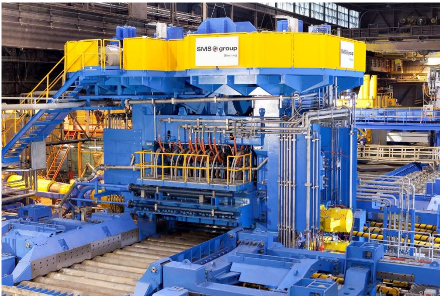
Das 4,3-Meter-Grobblechwalzwerk wird das mit 109 MN stärkste von SMS group gebaute Grobblechgerüst sein. Im Bild zu sehen ein vergleichbares Grobblechgerüst von SMS group.
