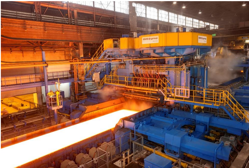
Vergleichbares Grobblechgerüst von SMS group.
