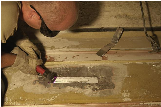
1: Die Demontage-Fachleute von Bombardier schätzen an dem Plasma-Schneidsystem TransCut besonders die leichte Handhabbarkeit und barrierefreie Mobilität: Stationärer Druckluftanschluss oder Gasflasche entfallen.
