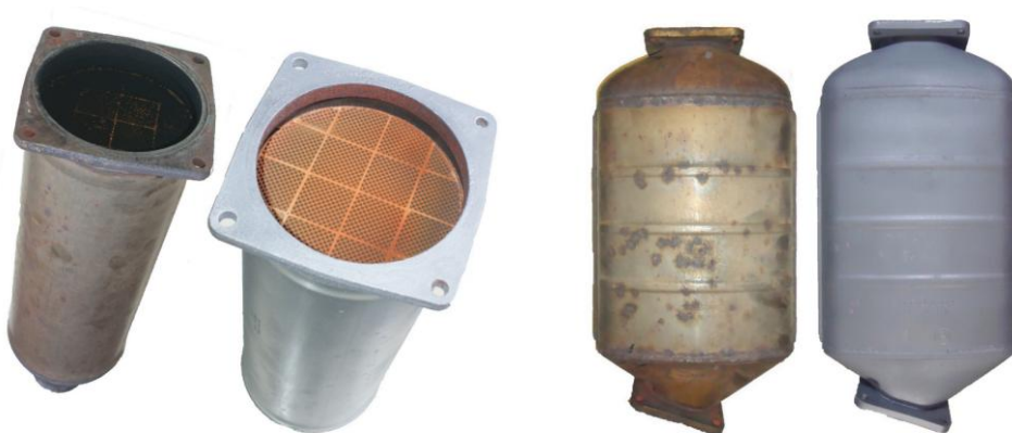
Professionell gereinigte Rußpartikelfilter im Vergleich vorher / nachher
