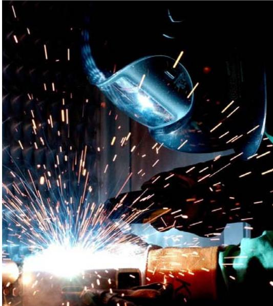
Die beim Schweißen entstehenden Metallspritzer können bis zu 1600°C Grad heiß sein und so die Fasern der Schweißer-Schutzkleidung schädigen. © wikipedia.org (Autor: William M. Plate Jr.)
