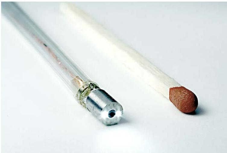
Im Rahmen des europäischen Verbundprojekts „Intracorporeal Videoprobe IVP“ wurden miniaturisierte Videosensoren für die Medizintechnik mit speziell angepassten HDRC® (High-Dynamic-Range CMOS) Bildsensoren, mikromechanischen Komponenten und Bildverarbeitungs- sowie Diagnose-Software entwickelt.
