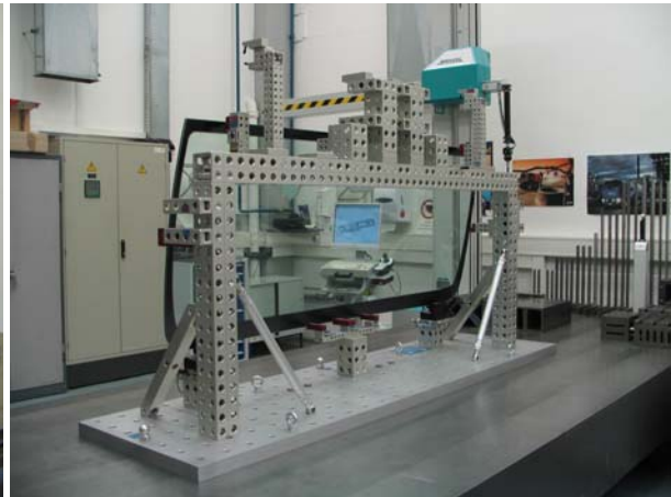
Alufix-Vorrichtung mit aufgenommener LKW-Frontscheibe (Vorder- und Rückansicht)
