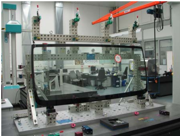
Alufix-Vorrichtung mit Aufsatz für Sonnenblenden. Mit wenigen Handgriffen wurde auf Aufsatz auf die Hauptvorrichtung gesetzt.
