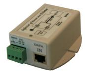
48V DC als Eingangsspannung. UBF EDV Handel und Beratung bietet jetzt ein Fast Ethernet Einspeisegerät (Injector / Midspan) an, das mit 9 bis 36V DC betrieben werden kann und eine Endgeräteversorgung von 48V DC nach Standard IEEE 802.3af bereitstellt. Somit kann PoE auch z.B. auf Fahrzeugen mit Batteriestromversorgung genutzt werden. Der Betriebstemperaturbereich von –25°C bis +75°C ermöglicht den Einsatz auch in nicht klimageschützten Bereichen.
