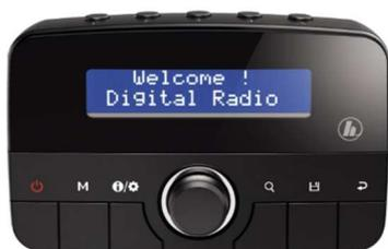
Der DAB-Adapter ist für rund 90 Euro im Handel erhältlich, bietet 30 lokale Favoritenspeicherplätze, fünf Schnellwahltasten zum direkten Senderaufruf, ein 2.0"-Display mit Hintergrundbeleuchtung und einen SMB-Anschluss zur Verwendung verschiedener Empfangsantennen. Per Bluetooth empfängt er zudem Audiodateien vom Smartphone oder Tablet und erweitert damit das Musikangebot nochmals ungemein.
