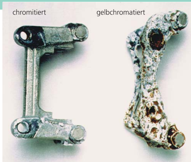
Links ein chromitiertes, rechts ein konventionell gelbchromatiertes Teil nach 2 Stunden Wärmebehandlung bei 200 °C und anschließend 240 h Salzprüfetest nach DIN 50021 SS.
