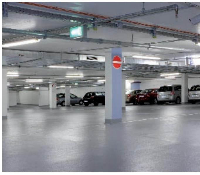
**Hochwertig: Dem Dortmunder Parkhaus „Freistuhl“ unter dem neuen RWE-Tower am Platz von Amiens wurde mit einer speziellen Hartkornsenschicht von Caparol der Boden bereitet.**
