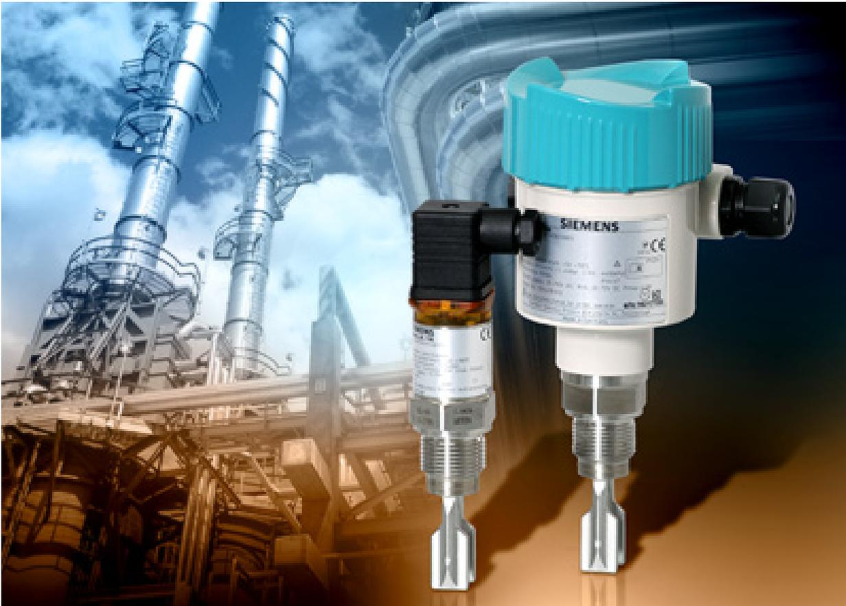
Die neuen Vibrationsschalter Sitrans LVL100 und LVL200 eignen sich für die Voll-, Bedarfs- und Leermeldung bei flüssigen Medien sowie zum Schutz von Pumpen. Die kompakten, bedienerfreundlichen Schalter messen zuverlässig auch bei sich ändernden Messbedingungen, etwa bei Schwankungen der Dielektrizitätszahl eines Mediums oder Dampf- und Blasenbildung. Sitrans LVL100 und Sitrans LVL200 werden in Speicher- und Prozessanwendungen eingesetzt und lassen sich an beliebige Meldesysteme anschließen.
