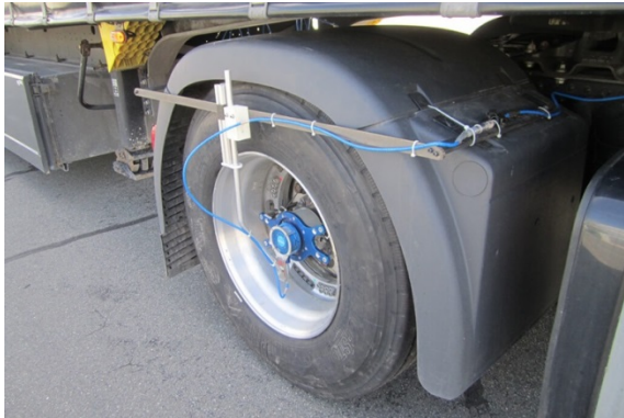
Vom Fraunhofer LBF gemessene radseitige Kräfte entsprechen Belastungen, denen Straßen ausgesetzt sind. Foto: Fraunhofer LBF
