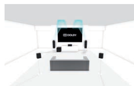
5.1.2: Standard-5.1-Konfiguration mit 2 Decken- oder Dolby Atmos-Lautsprechern
