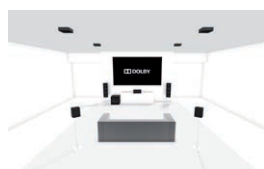
5.1.4: Standard-5.1-Konfiguration mit 4 Decken- oder Dolby Atmos-Lautsprechern
