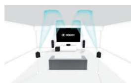
5.1.4: Standard-5.1-Konfiguration mit 4 Decken- oder Dolby Atmos-Lautsprechern
