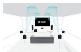
7.1.4: Standard-7.1-Konfiguration mit 4 Decken- oder Dolby Atmos-Lautsprechern
