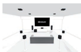
7.1.4: Standard-7.1-Konfiguration mit 4 Decken- oder Dolby Atmos-Lautsprechern
