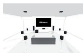
9.1.2: Standard-9.1-Konfiguration mit 2 Decken- oder Dolby Atmos-Lautsprechern
