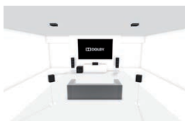
5.1.2: Standard-5.1-Konfiguration mit 2 Decken- oder Dolby Atmos-Lautsprechern
