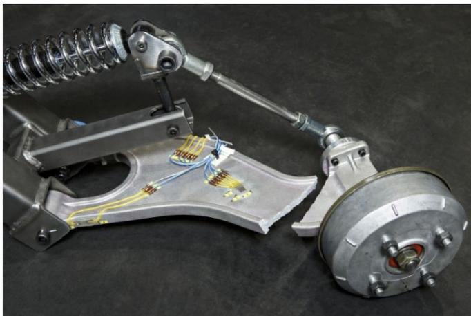
Geprüftes Halbachsmodul mit applizierten Dehnungsmessstreifen zum Abgleich der Ergebnisse der experimentellen und numerischen Spannungsanalyse.
