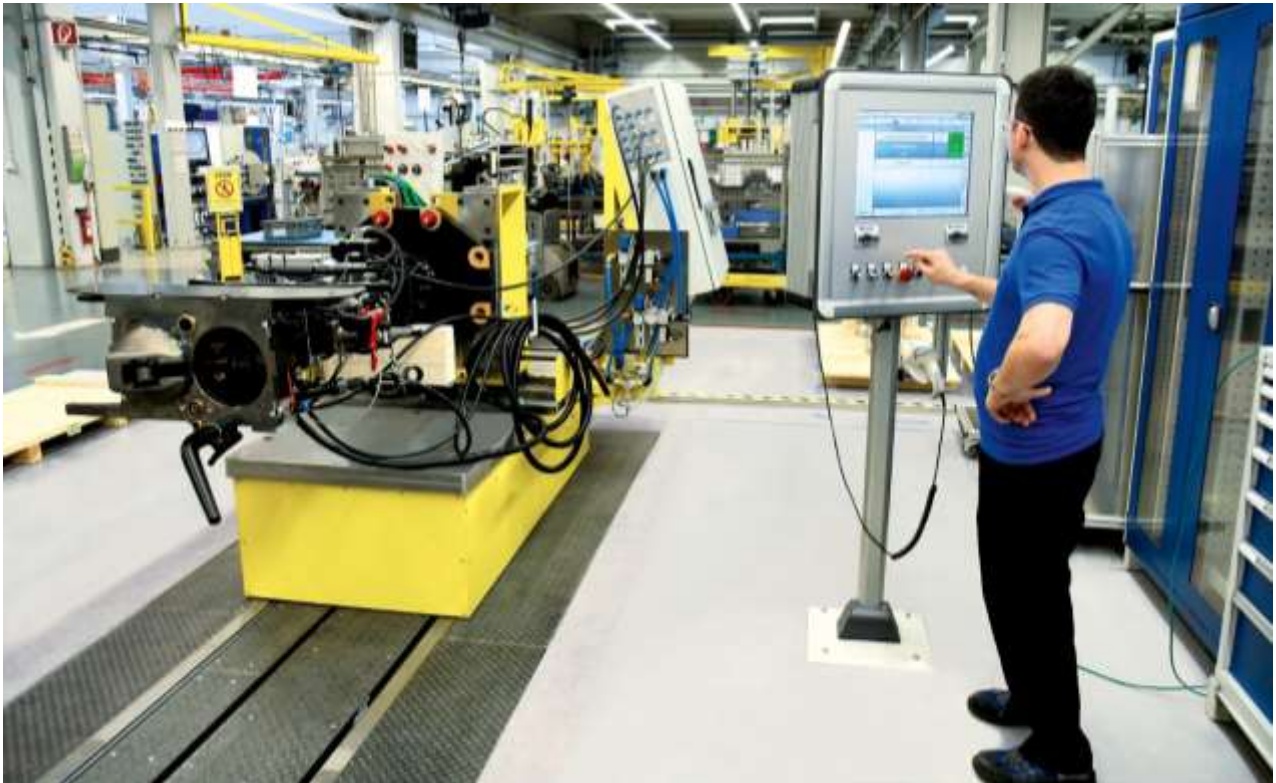
Abbildung 1: Prüfstand mit digitaler Werkerführung bei Voith Turbo in Salzgitter | Bild: Armbruster Engineering
