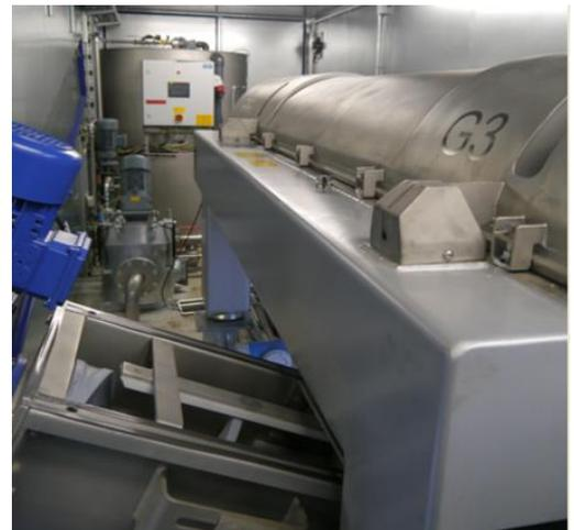
*Auf der IFAT 2016 präsentiert Alfa Laval ein komplett containerisiertes ALDEC G3 Dekanter-System, das mit allem ausgestattet ist, was bei den Feldtests für eine kosten- und energieeffiziente Eindickung und Entwässerung von kommunalen und industriellen Schlämmen benötigt wird.*
