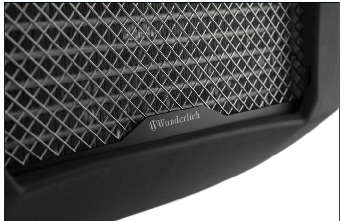
Der Wasserkühlerschutz wird zudem vibrationsentkoppelt befestigt
