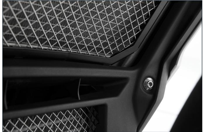
Beide Schutzgitter bestehen jeweils aus einem hochfesten, widerstandsfähig verschweißten Edelstahlgitter
