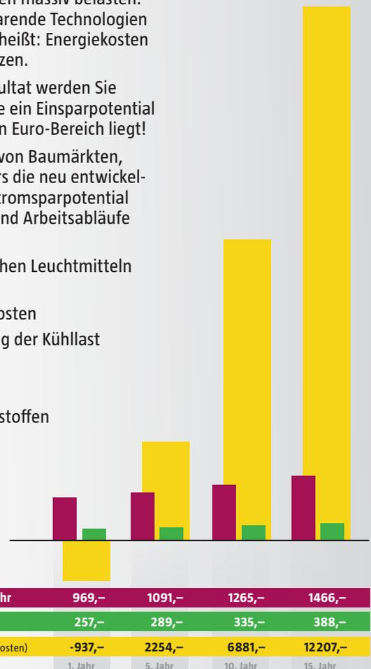
Beispielrechnung (in €) bei einem identischen Einsatz von LED-Röhren und Leuchtstofflampen: Die Energiekosten bei LED-Röhren liegen bei lediglich € 257,- im ersten Jahr. Die Amortisationszeit ist nach etwa zwei Jahren erreicht.
