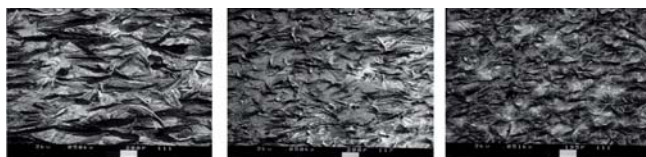
Variation der Verfahrensparameter beeinflusst das Schichtgewicht Dickschicht beschleunigte Dickschicht Dünnschicht 20-30 g/m² 12-17 g/m² 2-6 g/m² „Kaltumformung“ „Korrosionsschutz“ „Lacke“
