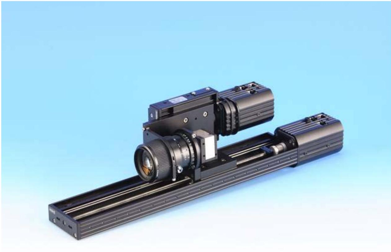
Das **TZS-1000-MOT** besteht aus zwei Verfahrachsen. Eine 25 mm Achse für die Vergrößerung und einer 300 mm Achse für den Fokus. Der Zoomfaktor beträgt ca. **4 : 1**. Die Ausbaustufe mit automatischen Wechsler der Konverter hat einen Zoomfaktor von ca. **10 : 1**. Die Zoombereiche werden in der Messsoftware Metric in 10 sinnvolle Vergrößerungsstufen unterteilt. (Änderungen auf Anfrage)
