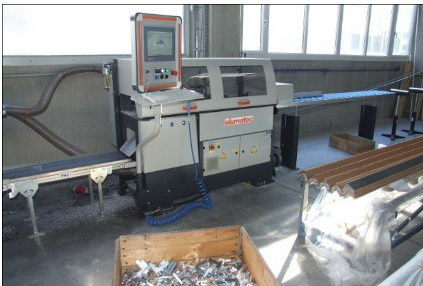
Sägeautomat SAS 142 für variable Massenzuschneide. Profilabhängige Parameter z.B. in Bezug auf Sägevorschub und Taktvorschub können hinterlegt werden.
