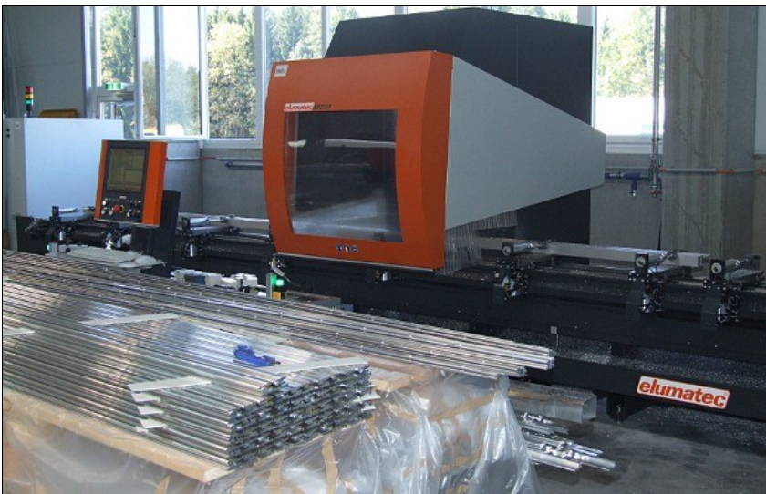
Das SBZ 130 ist für die Bearbeitung von Aluminium-, Stahl- und Edelstahlprofilen konzipiert. Auch im Pendelbetrieb kann gearbeitet werden.
