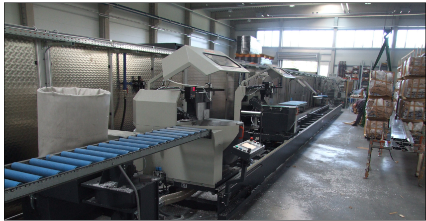
Auf dieser Doppelgehrungssäge DG 244 von elumatec können rund 16 m lange Profile gesägt werden. Alle Arten von Schifterschnitten sind möglich.
