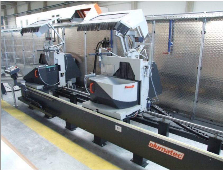
Doppelgehrungssäge DG 104 von elumatec: Auch hohe und breite Profile können gesägt werden. Die Sägeaggregate lassen sich universell schwenken und neigen.
