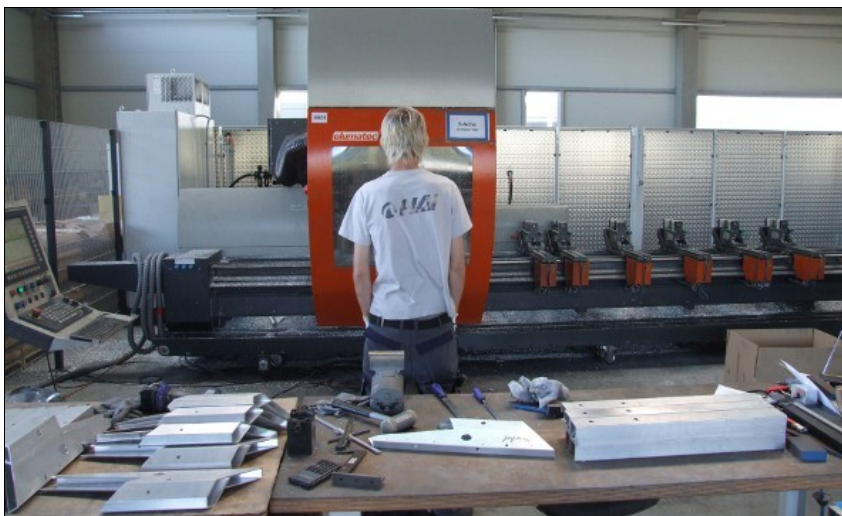
Bearbeiten und Sägen mit derselben Maschine: Auf dem 5-Achs-Zentrum SBZ 151 von elumatec können sowohl Langteile wie auch Kleinteile bearbeitet und erstellt werden. Die Herstellung von Kleinteilen ist ein automatisierter Prozess, der nicht beaufsichtigt werden muss.
