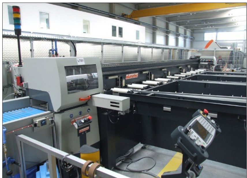
SAP 650: Sägeautomat mit elektronischem Pushersystem und automatischem Eintransport aus dem Vorlegemagazin. So lässt sich unterbrechungsfrei arbeiten.
