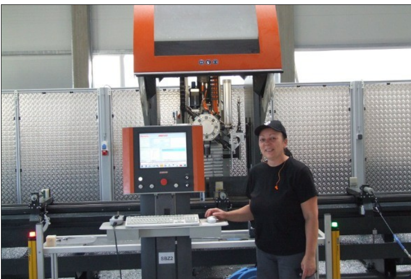
3-Achs-Zentrum SBZ 130: Ein Revolverkopf mit acht Werkzeugen sorgt für kurze Werkzeugwechselzeiten. Mit Winkelkopf ist die stirnseitige Bearbeitung der Profile möglich.
