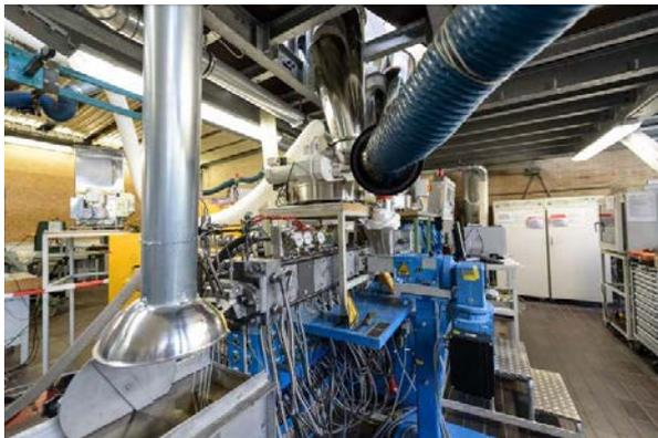
Hochleistungs-doppelschneckenextruder ZSK32MC mit modularer Entgasungseinheit im Fraunhofer LBF.
