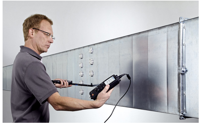
Abb. 3: Volumenstromkalibrierung vor Ort. Ein Service, um die maximale Genauigkeit an der Messstelle zu erhalten
