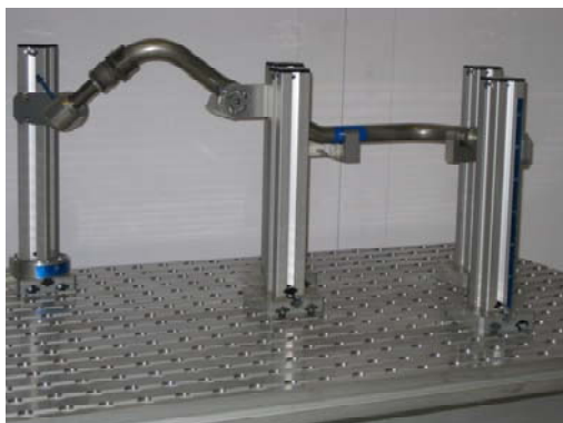
Foto links oben: A27 Pipe AQ1 : Reproduzierbare AQ-Vorrichtung bzw. Lehre mit fixierter Rohrleitung
