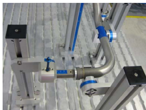
Foto links oben: A27 Pipe AQ1 : Reproduzierbare AQ-Vorrichtung bzw. Lehre mit fixierter Rohrleitung
