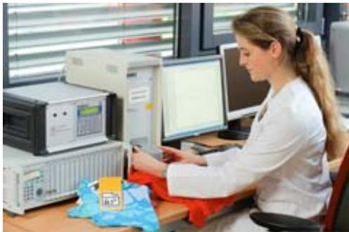
Die Bestimmung des UV-Schutzfaktors erfolgt mit Hilfe des Spektrophotometers. In diesem wird ein Lichtblitz erzeugt und ermittelt, welche Strahlungsmenge und -anteile vom textilen Material durchgelassen werden. Daraus wird der UV-Schutzfaktor errechnet.
