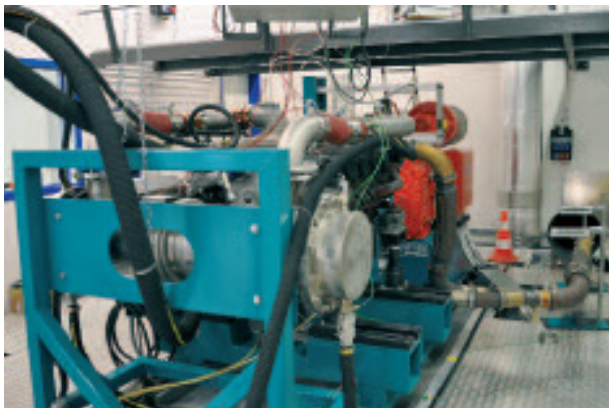
Der neue Prüfstand für (Lastwagen-)Motoren bis 4000 Newtonmeter Drehmoment.
