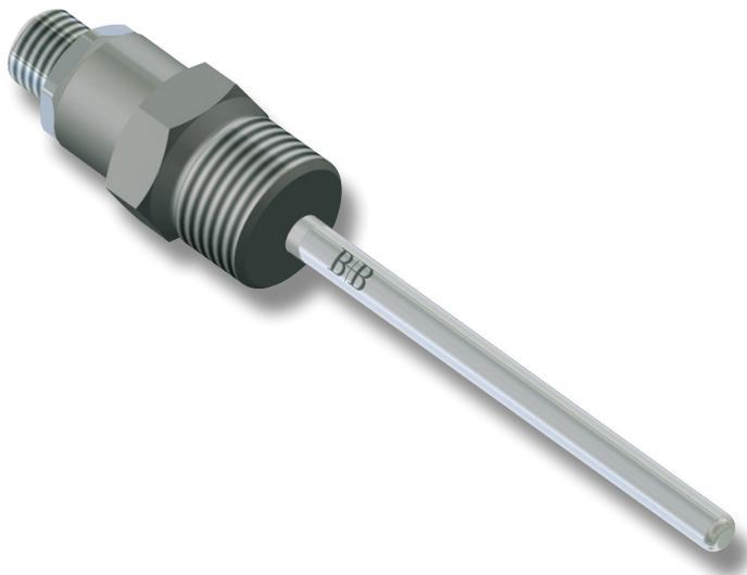
Einschraubfühler werden bevorzugt für Temperaturmessungen in flüssigen und gasförmigen Medien sowie in der Kunststoffindustrie zur Erfassung der Massetemperatur eingesetzt. Die zuverlässige Dichtheit dieser Einbauform bei Unter- als auch bei Überdruck ist ein wichtiges Auswahlkriterium. Der Einschraubfühler kann auch mit integriertem Messumformer 4...20 mA oder 0...10 V geliefert werden.
