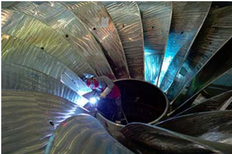
Abb.6: 200-t-Super-Turbinenrad: per Dreh-Kipptisch immer in der günstigsten Schweißposition Foto: EWM HIGHTEC WELDING
