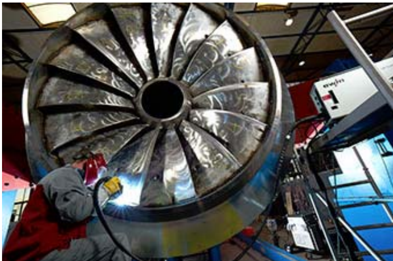
Abb.4: 25-Tonnen-Francis-Laufrad – allenthalben sind kerbfreie Nahtübergänge gefordert
