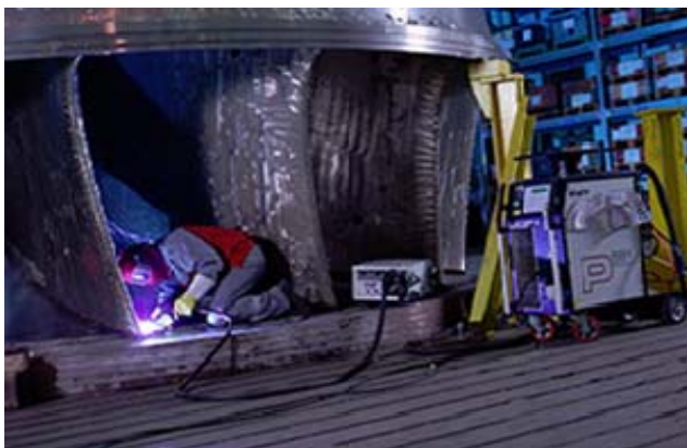
Abb. 7: Anforderungen an die Schweißnähte bei der Fertigung von Laufrädern: Kerbfreie Nahtübergänge an den Verbindungen Schaufel Nabe/Kranz; Schweißen in Schaufelkanälen in Positionen PB/PC, unter beengten
