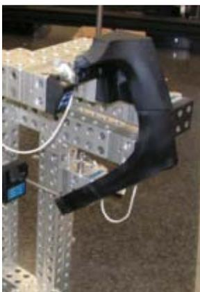
Photo 9: Ausschnitt Alufix Classic-Vorrichtung mit Rapid-Fit-Teilen
