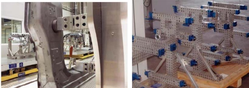
Photo 1, links: Aluminium-Konturteil im Einsatz mit Alufix
