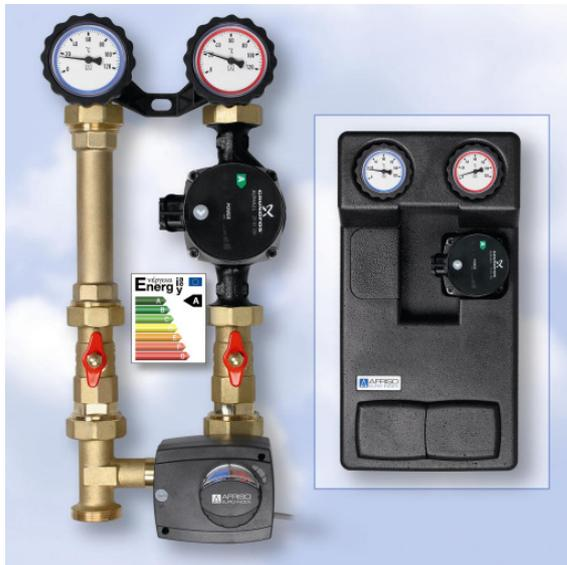
Heizungspumpengruppe PrimoTherm 180 von AFRISO – ein modulares System mit vielen Varianten: Mit oder ohne 3-Wege-Mischer, mit oder ohne Umwälzpumpe, mit oder ohne Überströmventil. Für geschlossene thermische Heizungsanlagen.
