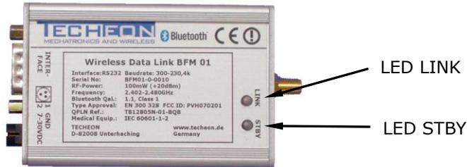
Nach dem Einschalten synchronisieren sich die Geräte selbständig. Das kann bis zu 30 Sekunden dauern. Während dieses Vorgangs leuchtet die LED LINK rot; nach erfolgter Synchronisation grün. Ist keine Gegenstelle zu erreichen, leuchtet die LED STBY.
