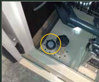
▲ Analoge Kraftstoff Niveau Anzeige
