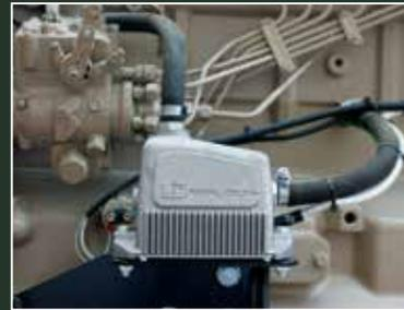
▲ Elektrische Standheizung (fremdversorgt)
