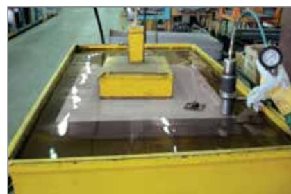
▲ Tankdichtigkeitsprüfung im Werk
