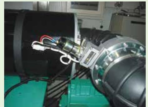
Die Ansaugluft-Schnellverschlussklappe gewährleistet die Notabschaltung des Dieselmotors.
