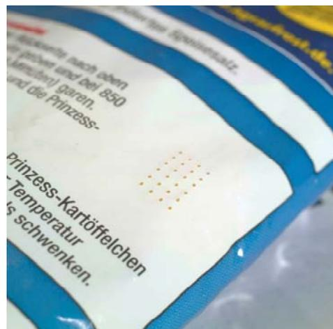
**Abb. 3:** Laserperforierter Bereich für Druckausgleich bei Mikrowellenverpackungen
