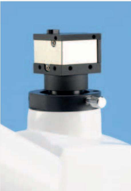
Bei Aufrüstung eines Trinokulars (mit einem dritten Schacht für eine Kamera) muss ein entsprechender C-Mount Adapter zur Verfügung stehen. Sollten Sie diesen nicht haben, können wir einen Adapter bei Angabe des Mikroskops mit genauer Typenbezeichnung mit liefern.
