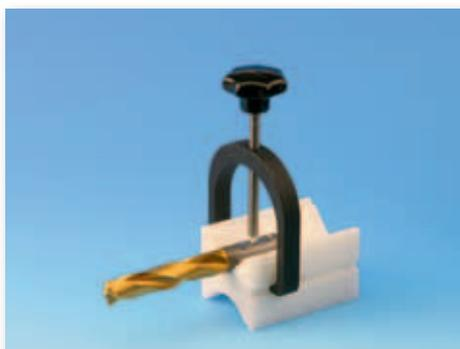
**CT-6000: Der Bohrermess- und Inspektionsplatz.** Ein extrem variabler Messplatz konstruiert für die schnelle und einfache Vermessung von Bohrern und ähnlichen Geometrien.
