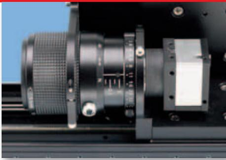
***TZS-1000 MOT: Das neue Schleifscheiben Messsystem.*** Zur Überprüfung der Kontur bei Schleifscheiben setzen wir telezentrische Optiken und Beleuchtungen ein. Nur dadurch können wir auf größere Distanz ein verzeichnungsfreies Bild erzeugen.
