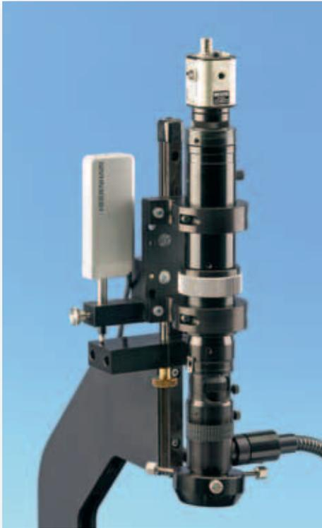
Ein Rastenzoomsystem besteht aus der eigentlichen Zoomoptik 6,5x oder 12x, einem Adapter mit Zwischenoptik von 0,5x bis 3,5x, dem C-Mount Adapter und der Kamera. Es wird nach Ihren Anforderungen oder einem gemeinsamen Test bei Ihnen im Werk zusammengestellt. Der Zoombereich kann durch zusätzliche Vorsatzlinsen verändert werden. Die Vorsatzlinsen entscheiden über den Arbeitsabstand.
