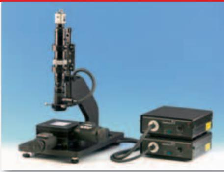
**Zoomsystem:** Muss die Vergrößerung sehr oft verändert werden, ist der Einsatz der Rastenzoomsysteme sinnvoller. Hierbei wird innerhalb des Zoombereiches der Arbeitsabstand nicht verändert. Zusätzlich verfügen die Zoomsysteme über eine höhere Tiefenschärfe als die CV-Systeme.
