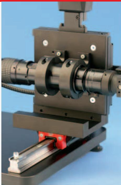
**CT-9000: Der Einachser unter den Dreien.** Dieses Modell ist für Vermessungen von Stirnflächen bei langen Rundteilen wie Bohrern oder Rohlingen mit Kühlkanälen entwickelt worden.
