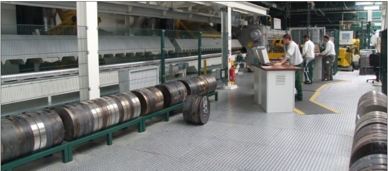
Schletter verfügt über eine eigene 3.300 Tonnen-Pressen, auf der die benötigten Profile hergestellt werden. Spezialisten am Leitstand steuern den kontinuierlichen Produktionsprozess und sorgen für die benötigte Qualität.
