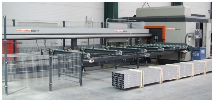
Das modular aufgebaute SBZ 610 automatisiert möglichst viele Bearbeitungsschritte. So sind hohe Stückzahlen möglich.
