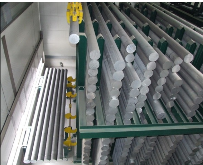
Das Lager fasst über 500 Pressbolzen, von denen jeder 8 m lang ist. Der Kran oben links bringt gerade eine rund 900 kg schwere Stange zur Presse.
