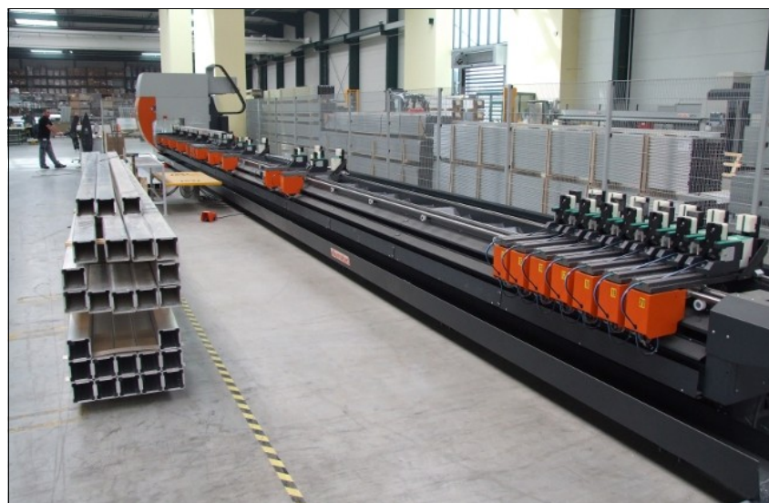
Das 5-Achs-Stabbearbeitungszentrum SBZ 151 von elumatec mit 18 m langem Maschinenbett. Bei Bedarf kann die Maschine auch pendelnd an zwei Stationen links und rechts auf dem Maschinenbett arbeiten.
