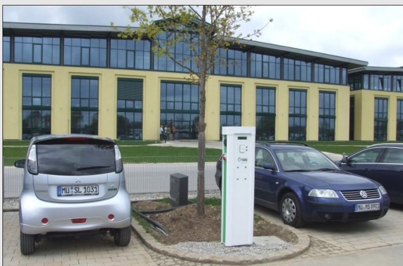
Elektro-Auto (links) mit Ladesäule. Bis zu vier Autos oder Elektro-Roller können an einer Ladesäule Strom tanken.
