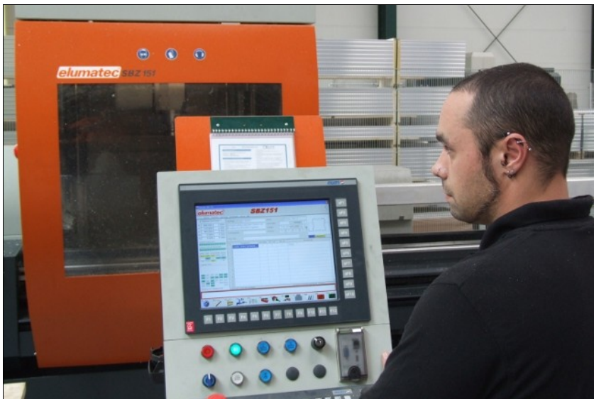
Mit der Programmiersoftware eluCad lassen sich schnell und einfach Bearbeitungsprogramme erstellen und in vielerlei Hinsicht optimieren.
