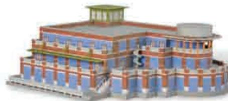
Der ZPrinter verwendet für die Zusammenstellung der Farben eine ähnliche Technologie wie ein Dokumentdrucker. Er wandelt die Farben der auf dem PC verwendeten RGB-Palette (Rot, Grün, Blau) für den Druck in die entsprechenden CMYK-Farbwerte (Cyan, Magenta, Gelb und Schwarz) um. Anschließend stellt er für jeden Bereich der zu bedruckenden Fläche die richtige Kombination von CMYK-Tröpfchen zusammen und mischt anhand von Dithermustern die gewünschten Farbtönen zusammen.
