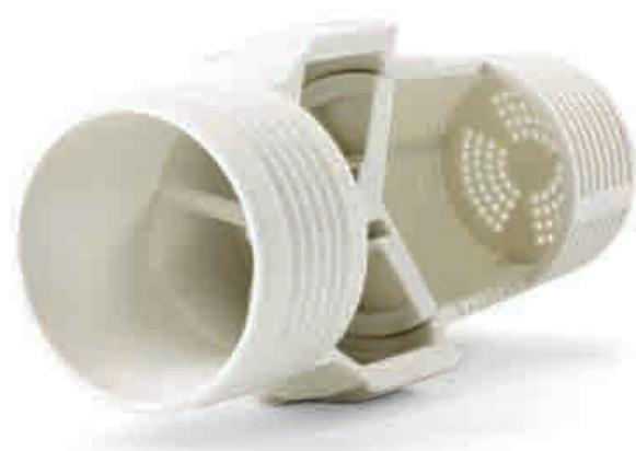
**Die Durchschnittskosten von 0,15-0,35 €/cm<sup>3</sup> beziehen sich auf den Kubikzentimeter Massivteil ohne Hohlräume des Bauteils. Demnach betragen die Fertigungskosten eines 143-cm<sup>3</sup>-Modells wie des oben dargestellten ungefähr 22 €.**
