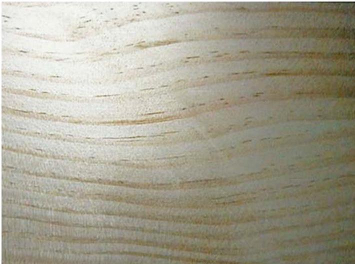
Abb 2: Holzmuster aus Abb. 1 nach einem weiteren Hobeldurchgang mit Riffelhobeln und Finishhobeln, trotz Drehwuchs entsteht eine saubere Oberfläche.
