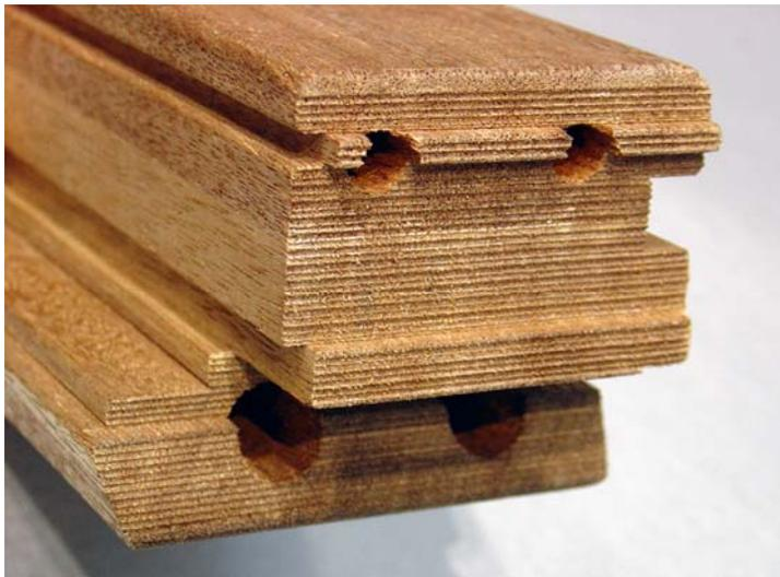
Abb 6: Querbearbeitung mit Riffeltechnik: Konterprofil Flügel innen mit Riffeloberfläche.
