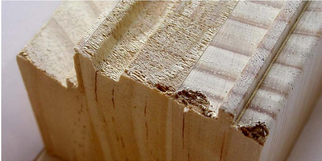
Abb 5: Querbearbeitung konventionell: Konterprofil mit typischen Aussplitterungen erzeugt durch gerade Schneiden, die beim Umfälzen nicht vollständig beseitigt wurden.
