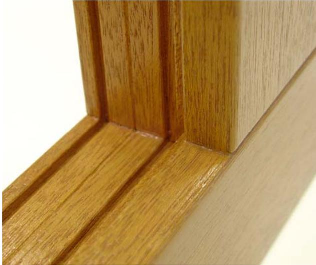
Abb 9: Optischer Eindruck einer Eckverbindung mit Riffelprofil. Auch quer zu den Riffeln sind die Fugen dicht. Durch die geringe Höhe der Riffeln bleiben sie optisch unsichtbar (Fotos: Leitz).
