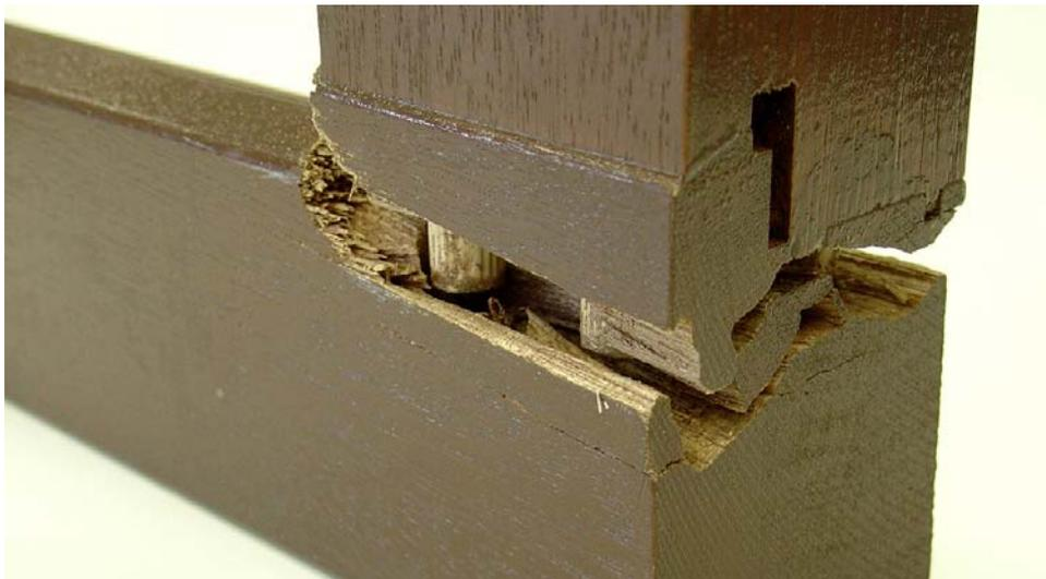
Abb 8: Typisches Bruchverhalten einer Eckverbindung mit Riffelprofil. Der Bruch erfolgt immer im Längsholz. Die Brüstungsfuge erscheint völlig dicht.
