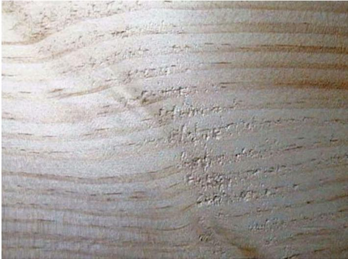
Abb 1: Konventionell gehobelte Oberfläche in einem Drehwuchsbereich. Die Vorspaltungen vom Vorhobeln werden beim Finishhobeln nicht beseitigt.
