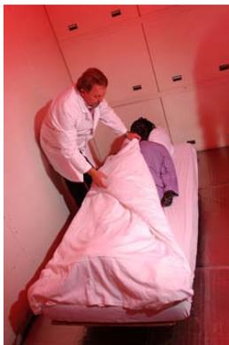
Mit Hilfe der Gliederpuppe „Charlie“ werden die thermophysiologicalen Eigenschaften konfektionierter Kleidung oder von Bettdecken gemessen. Durch Schlafversuche mit Testpersonen werden die Ergebnisse der Laboruntersuchungen bestätigt. Die Klimakammer ermöglicht dabei die Simulation verschiedenster Umgebungstemperaturen.
