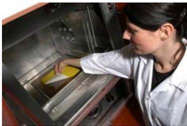
Mit dem Hautmodell können durch die Simulation der Wärme- und Schweißabgabe der menschlichen Haut verschiedene bekleidungsphysiologische Kennzahlen für ein Textil ermittelt werden.
